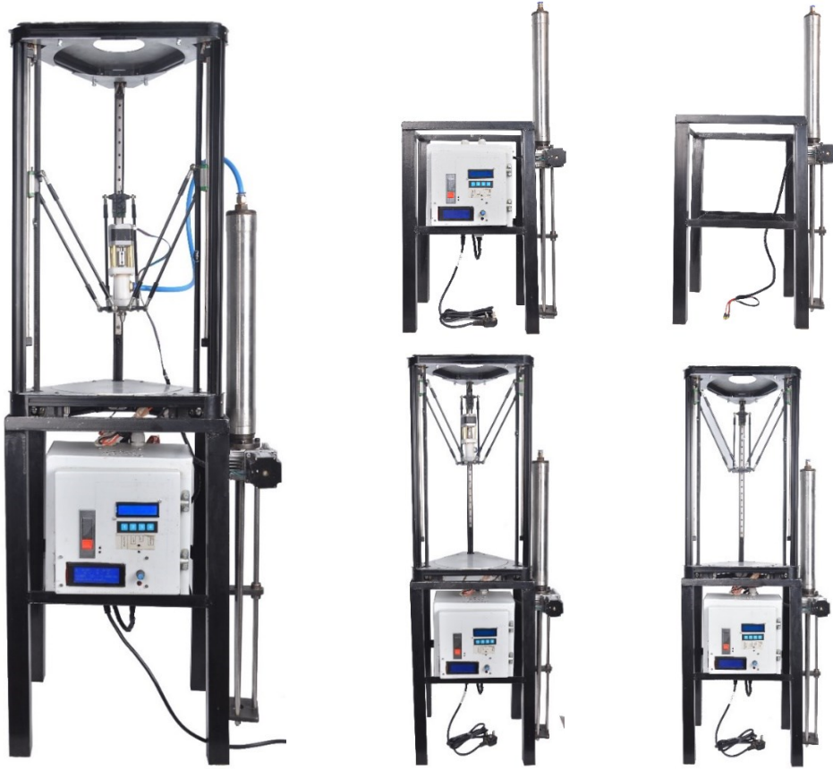
شكل (١٦): مراحل بناء الطابعة الخزفية ثلاثية الأبعاد ذات تحكم فعال.
